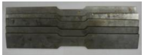
Fig. 1 Tensile test specimen(SCM415H)
