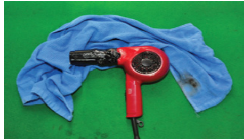
(d) Fire due to heat accumulation
