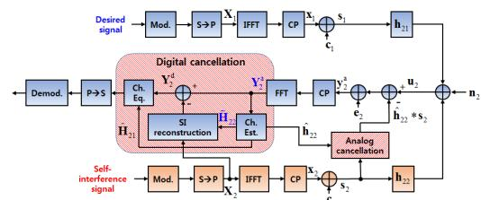
그림 3. SI 신호 제거 기법을 반영한 modem 2에 대한 동일대역 전이중 방식 통신 시스템 블록도
