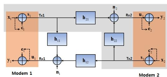
그림 1. 동일대역 전이중 방식 통신 시스템의 채널 모델
