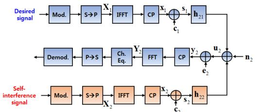
그림 2. Modem 2에 대한 동일대역 전이중 방식 통신 시스템 블록도
