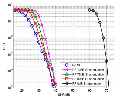
그림 6. 동일대역 전이중 방식 통신 시스템의 비트 오율 성능
