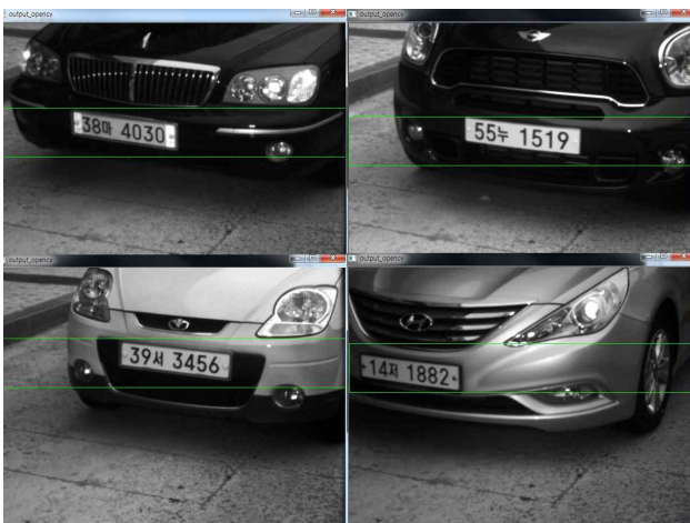
그림 6. Haar-like Feature 및 AdaBoost를 이용한 번호판 후보 영역 검출
