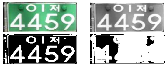
그림 10. (A) 번호판 원본 (B) 그레이 스케일 (C) OTSU 이진화 (D) 고정 임계치 이진화
