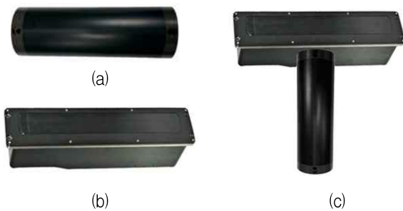
그림 5. (a)455kHz 프로젝터 (b) 128채널 수신기 (c)프로젝터와 수신기의 배치
