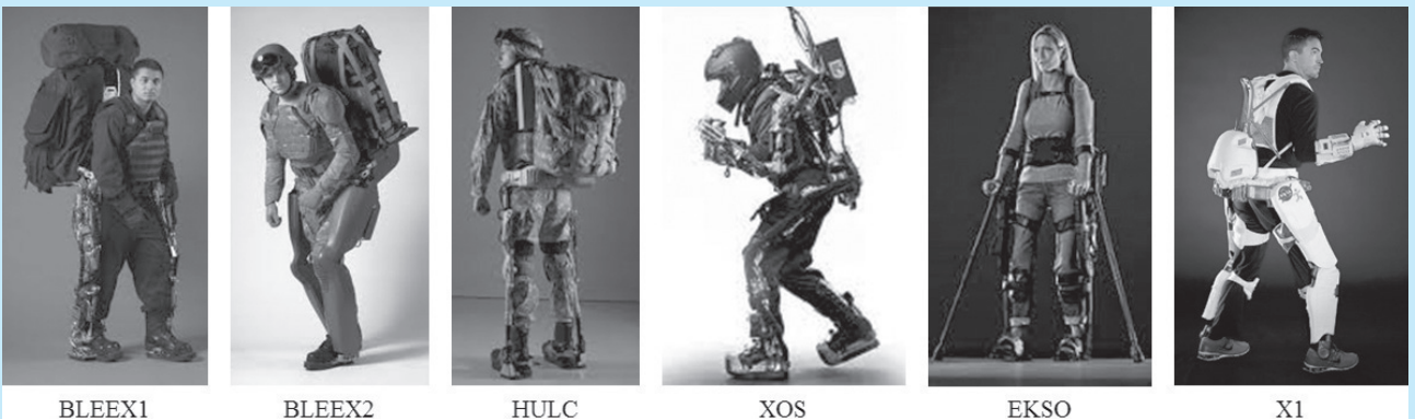
그림 4 미국에서 개발 중인 착용 로봇(왼쪽부터 U.C. Berkeley, Lockheed Martin, Raytheon, EKSO bionics, NASA)
