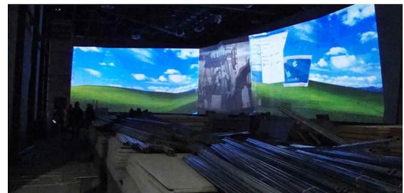
그림 6.엣지블렌딩(Edge-Blending) 테스트 장면
