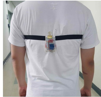
그림 10. 가속도 센서와 무선 통신모듈의 장착 위치 Fig. 10. Location of accelerometer and wireless communication module
