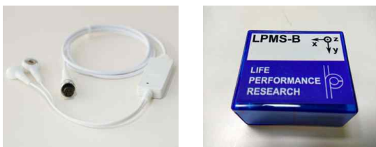
(a) 근전도 센서 (b) IMU 센서 그림 3. 실험에 사용된 근전도 센서 및 IMU 센서 Fig. 3. EMG and IMU sensor.
