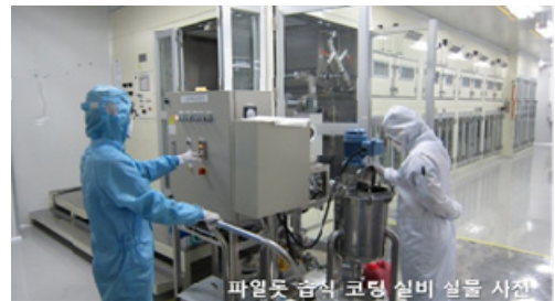
Figure 7. 롤투롤 습식코팅 장비 (a) 개념도, (b) 파일럿 스케일실물사진(한국화학연구원).
