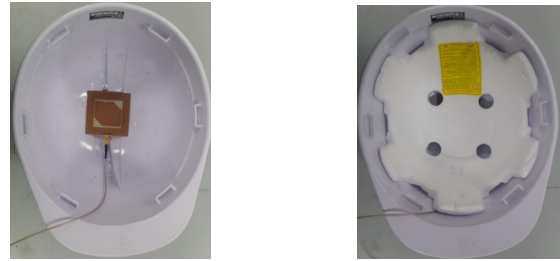
그림 11. 안전모에 부착한 패치 안테나 Fig. 11. Patch antenna attached to the safety helmet.
