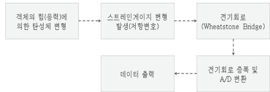
(그림 2) 로드셀의 객체 힘(응력) 측정 순서
