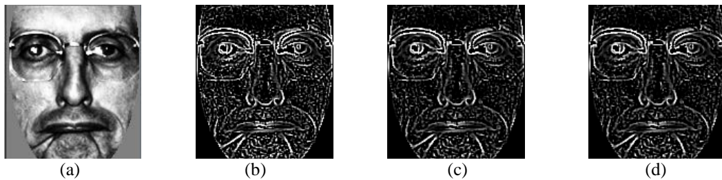
Fig. 1. Images of variations in LoG \sigma value: (a) original image; (b) \sigma : 0.1; (c) \sigma : 0.5; (d) \sigma : 1.
