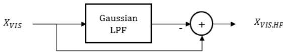
그림 6. 제안 알고리즘의 고주파 추출 과정 Fig. 6. HF patch estimation of the proposed algorithm.
