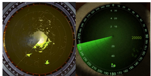
그림 5. CRT를 이용한 레이더(좌)Sweep강도 낮은 영상표출 (우)Sweep강도 높은 영상표출 형태
