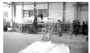
그림 3' 유압 기울기 장치 및 낙하완충장치 설치
