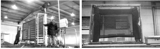
그림 4' 신규 장치를 이용한 어리장 이송 및 오리 낙하 작업
