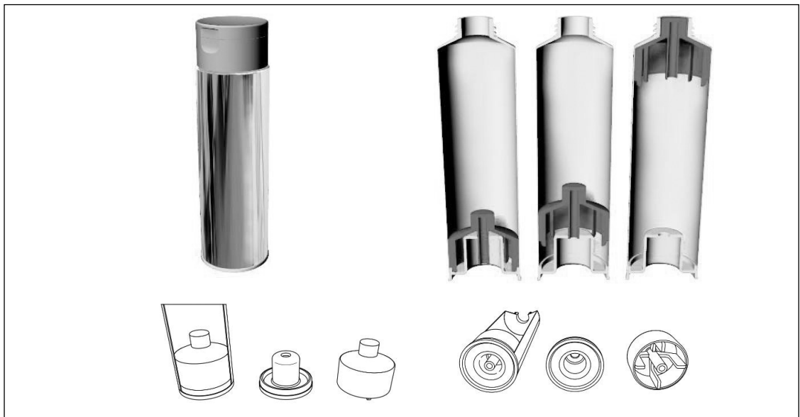
[그림 2] SMART TUBE(무잔량 튜브)
