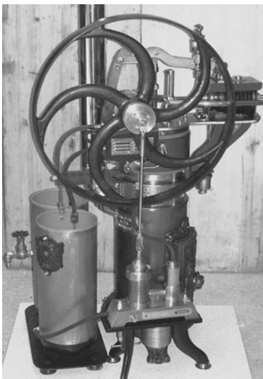
Fig. 1 단순유형의 \gamma -type stirling engine
