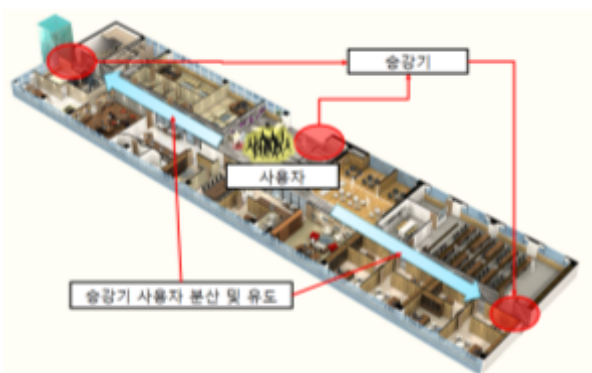
그림 1. 승강기 탑승인원 분산을 위한 탑승경로 유도 시스템 구성
