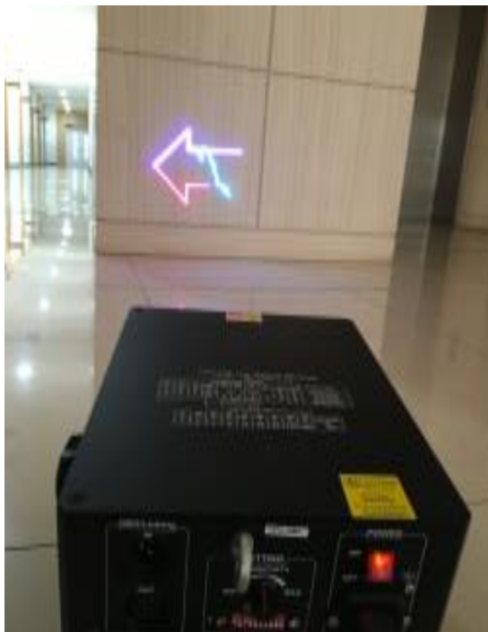
그림 3. 승강기 탑승인원 피난 유도 표지부인 LED 패턴
