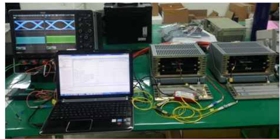
그림 15. FC eye 패턴과 지터 시험 환경 Fig. 15. FC eye pattern and jitter test environment.
