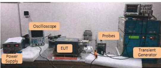
그림 11. 케이블 유도 시험 구성 Fig. 11. Cable induction test setup.
