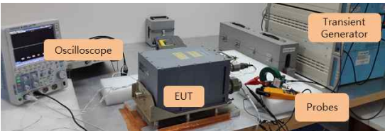
그림 10. 직접주입 시험 구성 Fig. 10. Direct injection test setup.
