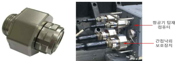
그림 1. 간접낙뢰 보호장치 형상 Fig. 1. Indirect lightning protection device figure.
