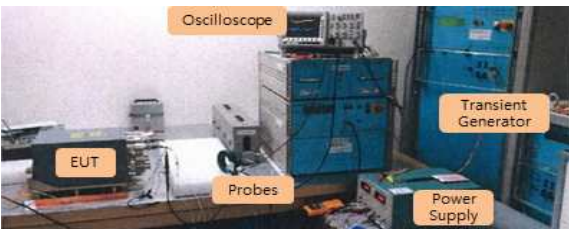
그림 12. 접지 주입 시험 구성 Fig. 12. Ground injection test setup.
