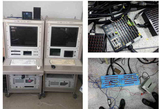
그림 13. 결함주입기법 기반 검증시험 구성(VEP test bench) Fig. 13. Facility configuration of fault injection based verification(VEP test bench).
