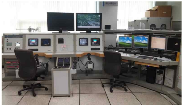
그림 12. 결함주입기법 기반 검증시험 구성(MEP SIL) Fig. 12. Facility configuration of fault injection based verification(MEP SIL).
