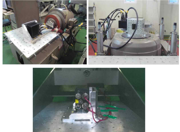
그림 11. 변경된 회로의 환경요구도 충족 입증시험 Fig. 11. Re-designed circuit proof testing for environmental requirement satisfaction.
