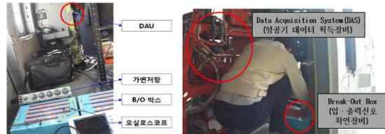
그림 14. 결함주입기법 기반 항공기 지상시험 구성 Fig. 14. Ground test configuration of fault injection based verification for aircraft.
