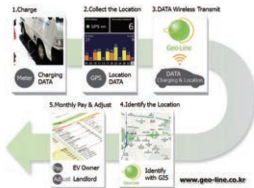
〈그림 5〉 Geo-Line 충전 작동순서
