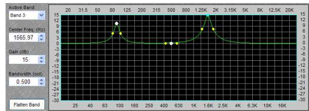
그림 1. EQ의 필터 규격 설정 구조와 최종 주파수 응답의 그래픽 표현 Fig. 1. Input of filter specification and graphic visualization of final frequency response of EQ
