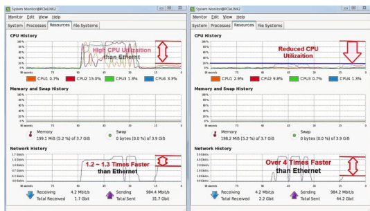
그림 22. Linux vsftpd 시험 결과 (좌: memcopy 기반, 우: DMA 기반) Fig. 22. vsftpd test result. (left: memcopy based, right: DMA based)
