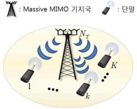
그림 1. 다중 사용자 massive MIMO 하향링크 시스템
