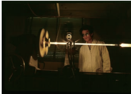
그림 1. MCVD 법에 의한 광섬유 제작
