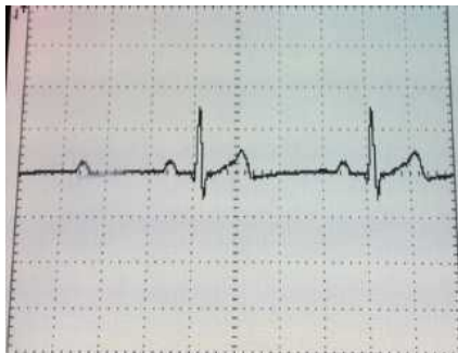
그림 4 오실로스코프로 측정된 PWM 출력 (NSR60)
