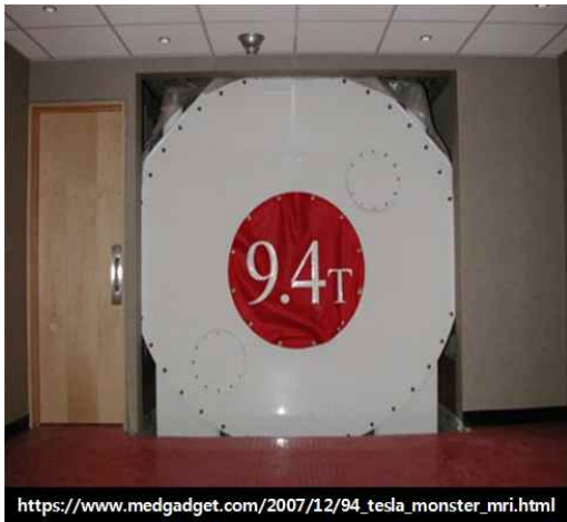
그림 4. University of Illinois at Chicago (UIC)대학 병원에 설치 운영 중인 전신촬영 용으로는 세계 최고 자장인 9.4 T의 MRI 시스템.
