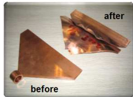
그림 3. 커패시터 뱅크를 이용한 단권(single-turn coil) 파괴형 펄스 전자석의 사용전과 사용 후 모습. (그림제공 : International MegaGauss Research Institute, University of Tokyo).
