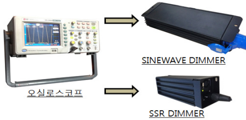
그림 6. IGBT 사인웨이브 디밍 시스템과 SSR, SCR 디밍 시스템 측정 방법 Fig. 6. Measuring System to Measure the Waveform of IGBT SINEWAVE Dimming System and SSR, SCR Dimmer System
