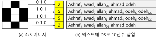
그림 2. (a) 이진 이미지 워터마크와 이것의 10진수, (b) 워터마크 예제로 첨자는 공백의 개수이다. Fig. 2. (a) Binary image watermark and its' decimal number, (b) Example of watermarked words with spaces and suffix is number of space.
