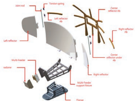
〈그림 6〉 MCSAR 다중대역 안테나 공학모델(EM) 설계
