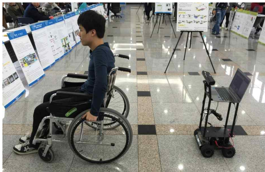
그림 10. 자율주행 쇼핑카트 시제품 Fig. 10. Prototype of autonomous shopping cart
