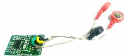
그림 6. 실험 및 검증을 위한 소형 생체신호 측정모듈
