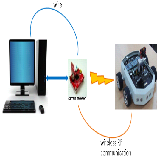
그림 1. 원격 제어 로봇 시스템의 구성 Fig. 1. Structure of remote control robot
