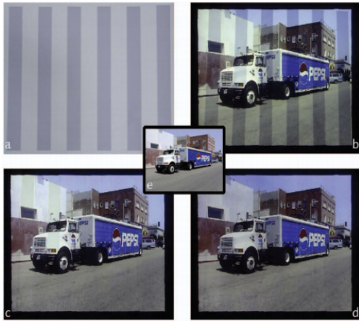
그림 10. 패턴과 색깔을 지닌 특이한 평면에 증강정보를 표현할 때의 보정 과정 [6].
