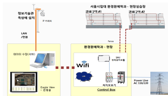
그림 8. 시스템 구성 및 현장설치 Fig 8. System Configuration and Installation.
