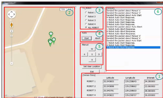
그림 8. 관제 센터의 무인기 상태 감시 및 제어 GUI Fig. 8. The GUI to monitor a robot vehicle condition and to control it from ground control center
