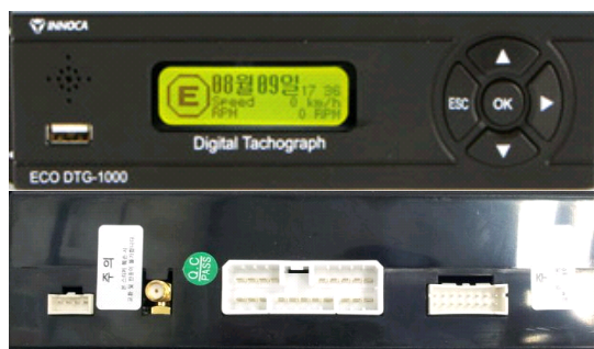
그림 2. 디지털 운행기록장치 전면부 및 후면부 사진(16) Fig. 2. Front and Rear of the Digital Tachograph(16)
