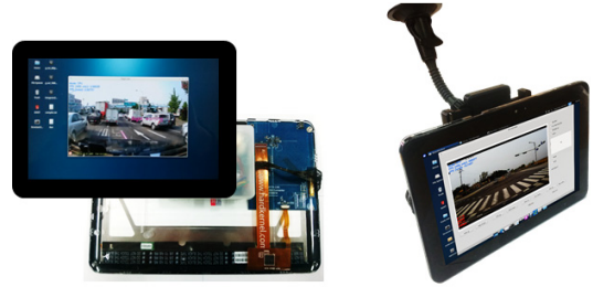
그림 3. 스마트 차량용 카메라 장치 시제품 Fig. 3. Smart vehicular camera prototype device
