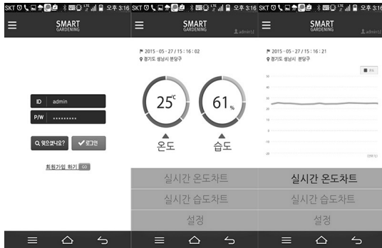
(그림 5) 스마트가드닝 시스템 User Interface (Figure 5) User Interface of Smart Gardening System
