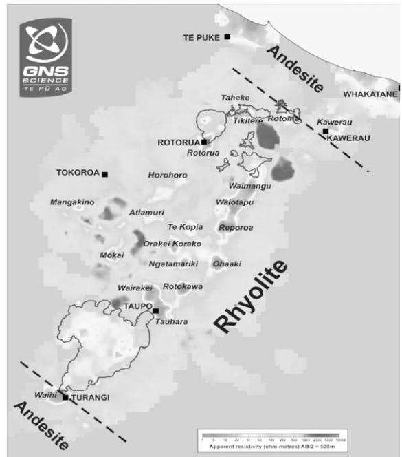
[그림 5] TVZ 전기비저항 이상도; 고온의 지열 시스템의 위치와 따듯한 색깔로 표현된 저비저항 이상지역이 잘 대비된다(Bibby et al., 1995).
