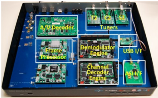
그림 12. DVB-X2 수신기 구현 Fig. 12. Implementation of DVB-X2 receiver
