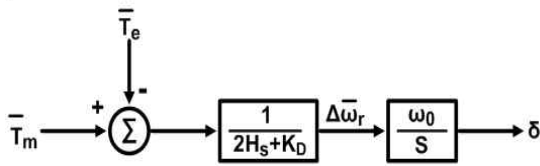
그림 3. 전력방정식의 블록다이아그램 Fig. 3. Block-diagram of power swing equation
