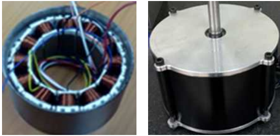
그림 11. U-type BLDC모터 시제품 Fig. 11. U-type BLDC motor prototype
