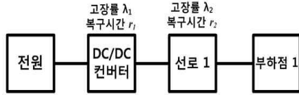
그림 3. Minimal cut-set 방식을 통한 신뢰도 블록다이아그램
