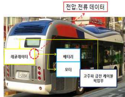
그림 8. 전력수전부 계측 장비 설치 Fig. 8. Measurement Equipment Installation of Power Receiving Part
