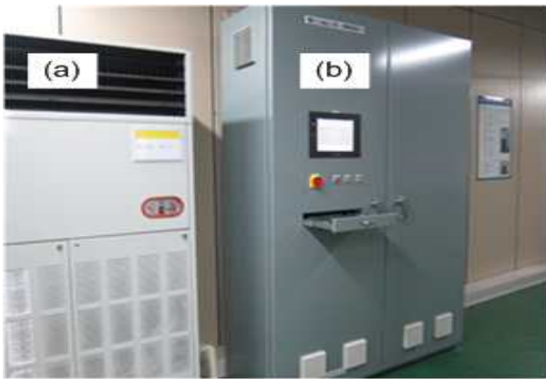
그림 3. 케이블의 (a) 부하전류 및 (b) 표면온도 측정 장치 Fig. 3. Load current and surface temperature measuring device of the cable
