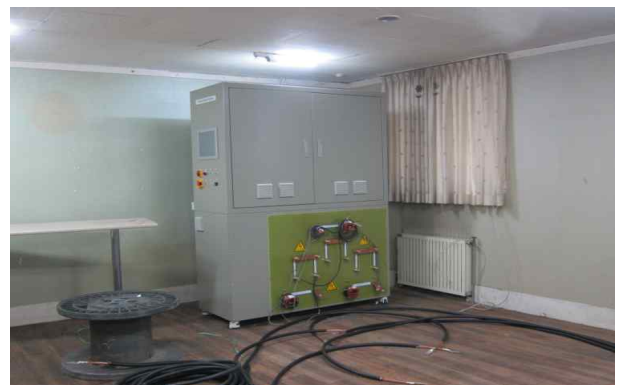
그림 4. 도체 온도, 표면온도 변화 장치 Fig. 4. Surface temperature of the conductor temperature conversion device
