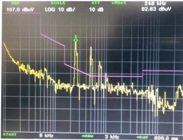
그림 9. 수동 EMI 필터의 측정 그래프 Fig. 9. Measurement Graph of Passive EMI Filter
